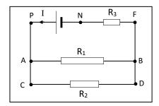
On donne :  $U_{PN}$ = 12 V ;  $R_1$ = 12  $\Omega$  ;  $R_2$ = 47  $\Omega$  et  $R_3$ = 33  $\Omega$ .
