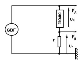
Le sélecteur de base temps doit être sur la position XY.
