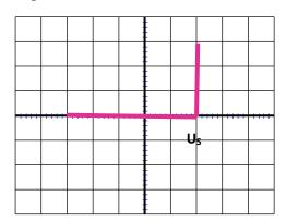
La diode idéale est une diode parfaite sans tension seuil ( $U_S = 0$ ).
