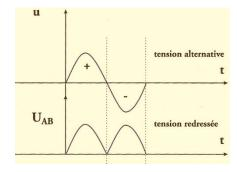
Quel que soit le signe de U, U<sub>AB</sub>> 0 : la tension est donc redressée et on a une double alternance.
