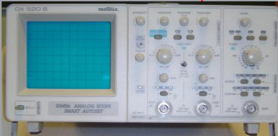
Un oscilloscope est un appareil qui permet de visualiser une tension électrique répétitive.
