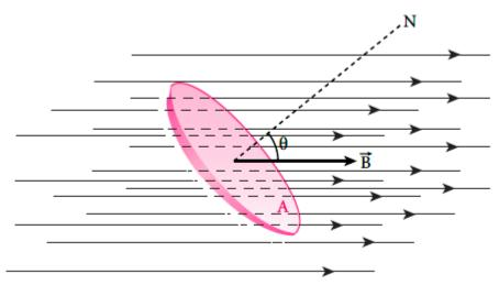
La densité du flux magnétique dépend du flux magnétique traversant la zone A :
